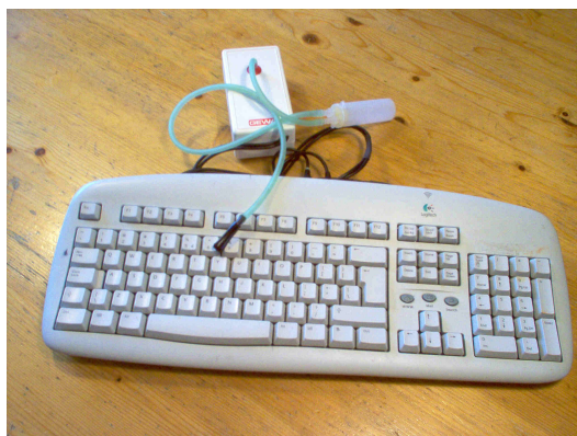
Foto 1. Zuigblaasschakelaar gekoppeld aan een toetsenbord. Een keer zuigen staat gelijk aan het indrukken van een toets die wordt opgevat als ‘-’ en een keer blazen aan het indrukken van een andere toets die wordt opgevat als ‘.’.
